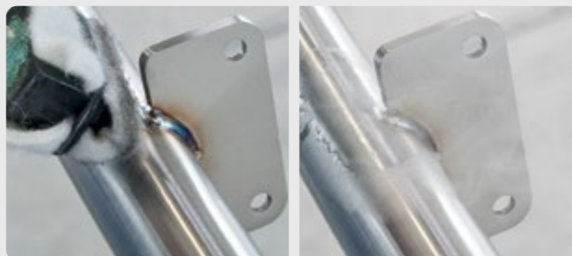
Die Schweißnähte eines Leiternholms werden durch das Beizen gereinigt.
